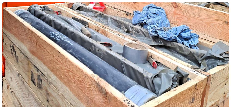
Lagerung von Bohrkernen in Kernkisten
